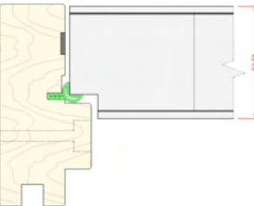
Karmprofil av klimadør. B30/Rw38dB dør, 52mm dørblad
